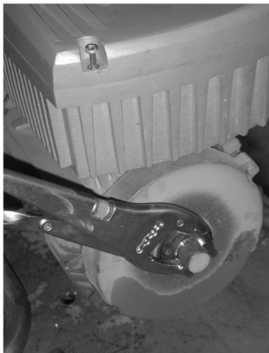
Note : afin de faciliter l'extraction du rotor (20), lubrifier l'entrée du stator (1) par l'ouverture du corps (50) en utilisant de la glycérine (voir section "Remontage", page 24).
