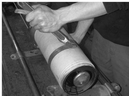
Sur le modèle 13M24S, le stator (1) est muni de deux anneaux de centrage (52) à ses extrémités, étanchés par deux joints toriques (14). Vérifier l'état des joints (14) et les changer si nécessaire lors du remontage.
