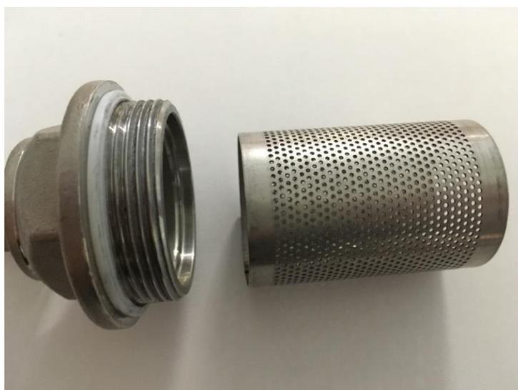
Fig. 36 Nettoyage soigneux du tamis pour les conduits
