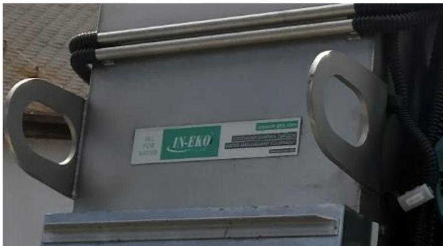
Fig. 17 Détail d'un œillet d'arrimage
