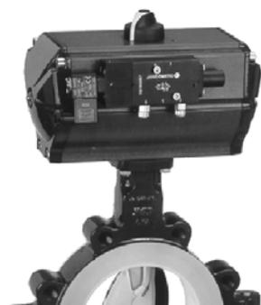
Un distributeur à pilotage électrique ou pneumatique à embase NAMUR peut être fixé en applique directement sur le plan de pose situé sur le côté de l'actionneur.
